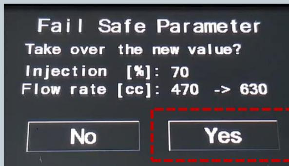
Im Display werden entsprechend angezeigt, bei wieviel % Ansteuerung der Einspritzung der Fehler erkannt wurde. Des weiteren wird angezeigt welcher Durchfluss Wert gemessen wurde und die aktuell gesetzte Durchflussgrenze.
