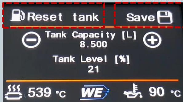
Der Tankinhalt muss dem System vorgegeben werden damit der Rest Tankinhalt genau angezeigt werden kann. Das WIC berücksichtigt dabei die entnommene Menge und errechnet den Restinhalt.
