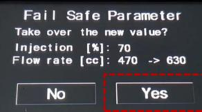
Im Display werden entsprechend angezeigt, bei wieviel % Ansteuerung der Einspritzung der Fehler erkannt wurde. Des weiteren wird angezeigt welcher Durchfluss Wert gemessen wurde und die aktuell gesetzte Durchflussgrenze.
