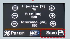
Diese Einstellung ist wie folgt zu verstehen: Bei 70% Ansteuerung ist der Durchfluss auf 630 cc bzw. 630 ml gesetzt. Der zulässige Durchfluss liegt hiermit zwischen 480 cc und 780 cc (630 +/- 150 cc) Achtung: nach dem Anlernvorgang speichern der Parameter nicht vergessen
