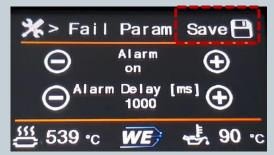
Des weiteren ist eine Alarm Verzögerung zwischen 750ms und 1000ms sinnvoll. Vergessen sie nicht die Einstellungen zu speichern
