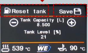
Der Tankinhalt muss dem System vorgegeben werden damit der Rest Tankinhalt genau angezeigt werden kann. Das WIC berücksichtigt dabei die entnommene Menge und errechnet den Restinhalt.
